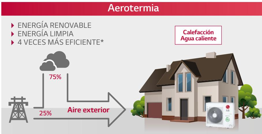
\*En comparación con una caldera de gas o de aceite. Con la aeroterminia podemos obtener en forma de energía térmica hasta 4 veces la energía eléctrica invertida en el proceso.
