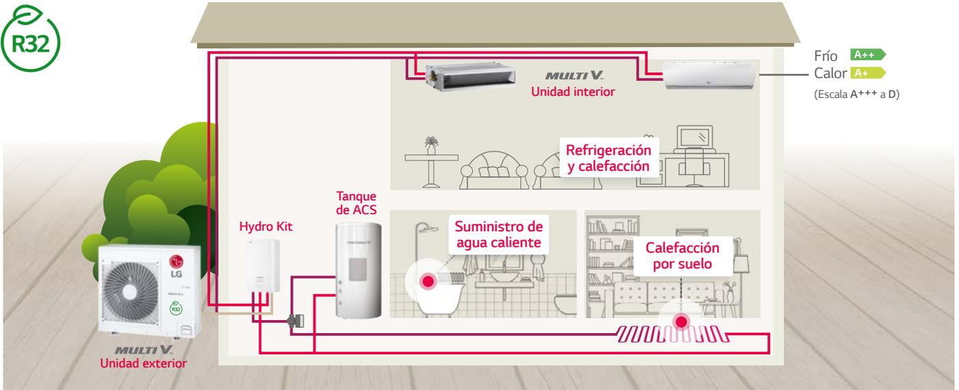
La **aeroterminia mixta** utiliza la tecnología **VRF** para, gracias a la energía obtenida del aire, producir ACS y climatizar la vivienda
